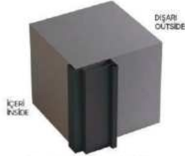
Dışardan Geçme Dışa Açılır Kasa (Rus Tipi) External Mounted Fixed Frame-Opening Outwards (Russian Type)
